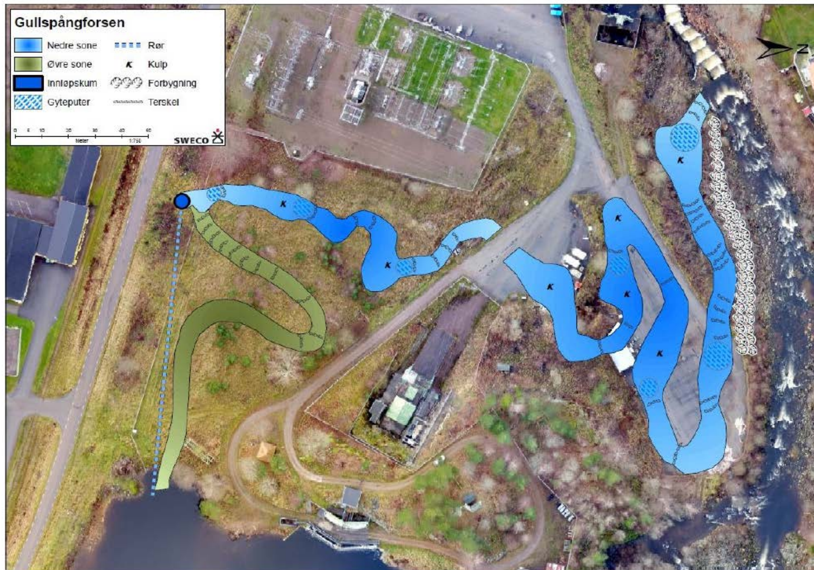
Figur 39. Konceptuellt förslag till utformning av en lekkanal ("spawning channel"). Förslaget är utformat utifrån områdets topografiska förhållanden. Tillstånd till spridning enligt beslut från Försvarsmakten; beteckning 10830: 82148.
